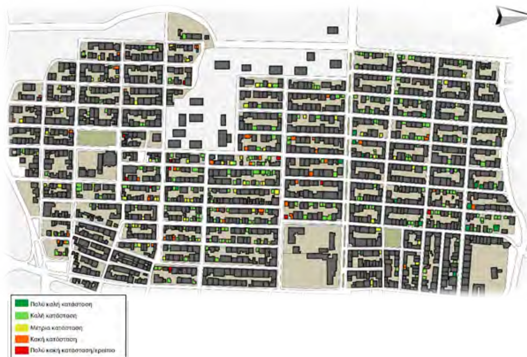
Σχήμα 19. Χάρτης κατάστασης διατήρησης των υφιστάμενων προσφυγικών κατοικιών.
