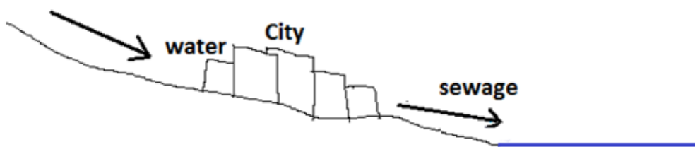
Σχήμα 2. Υπόδειγμα προτύπου συστήματος υδραυλικής ροής: το αρχαϊκό μοντέλο που ακολουθεί το φυσικό ανάγλυφο (βαρυτικό)
